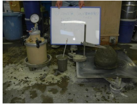
スラッジコンクリート (スランプ° 13.0cm)
