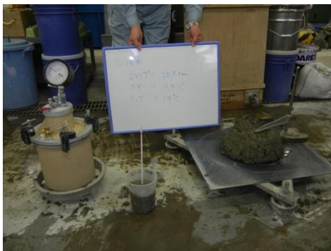
AE 減水剤標準形 コンクリート温度 20°C スランプ° : 20.0cm
