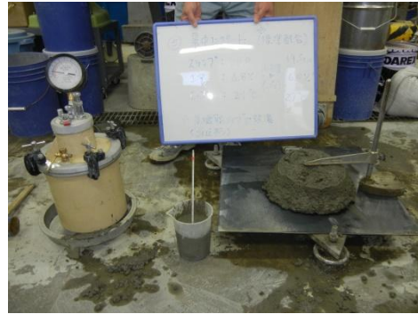
同コンクリート 30 分静置後 スランプ° : 19.5cm
