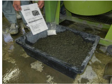
0.25m 3 に対して 200g 添加・団粒化 10ℓのコンクリートに 8g 添加、2.5 分攪拌
