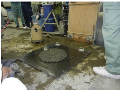
スランプ フォーム引上げ直後
