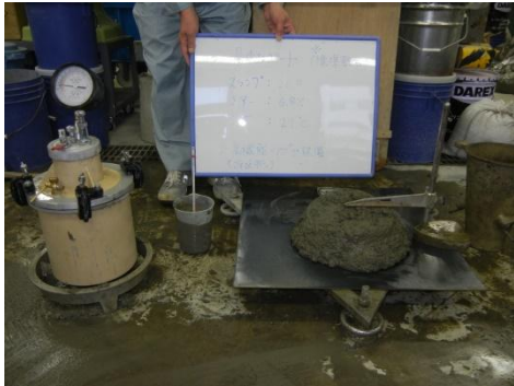
高機能 AE 減水剤遅延形 コンクリート温度 29℃ スランプ° : 20.0cm
