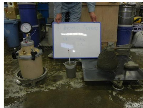
AE 減水剤標準型 コンクリート温度 31°C スランプ° : 8.5cm
